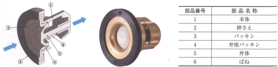
図Ⅱ-1 1-3 0 逆止弁付メーターパッキン
