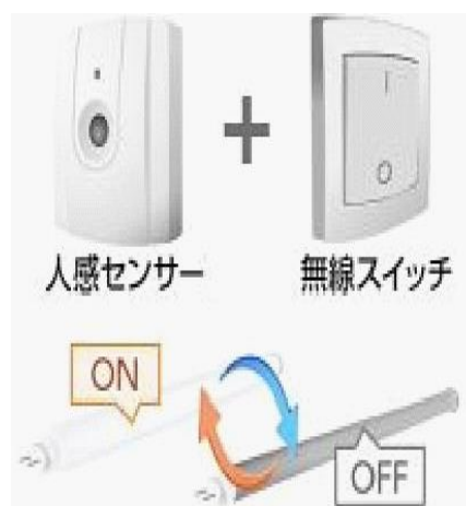
トイレ照明人感センサー方式
