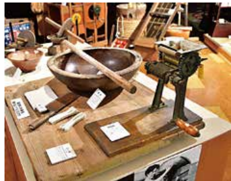
昭和時代の製麺機。ギアを切り替えることで生地をのす工程と、細く切り分ける工程の両方をこなすことができます。
