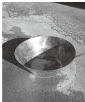
煙をほとんど出さずに剪定枝を炭素化できる無煙炭化機 JAでは農家へ貸し出す予定
